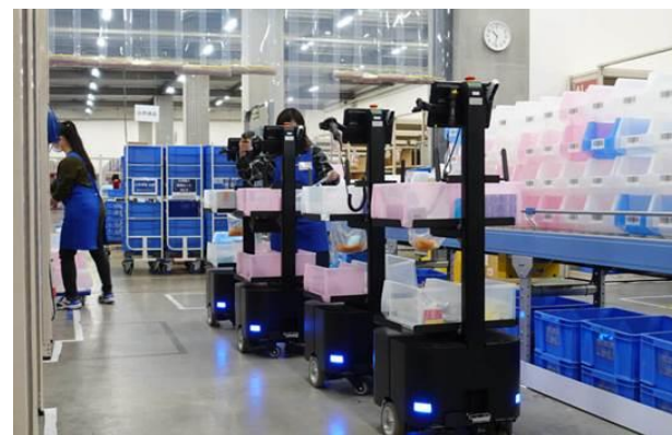
AMR:協働型ピッキングアシスタントロボット
